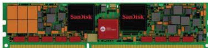
**Fig. 2** – Le nuove ULLtraDIMM sono prodotte da SanDisk con la tecnologia Memory Channel Storage di Diablo Technologies con capienza di 200 o 400 GByte e latenza inferiore a 5  $\mu$ s
