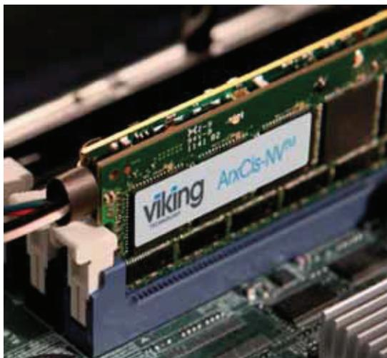
**Fig. 3** – Le memorie NVDIMM ArxCis-NV di Viking Technology montano al fianco delle DRAM anche un banco di Flash dove ne viene continuamente ricopiato il contenuto senza penalizzare la velocità di lavoro della CPU
