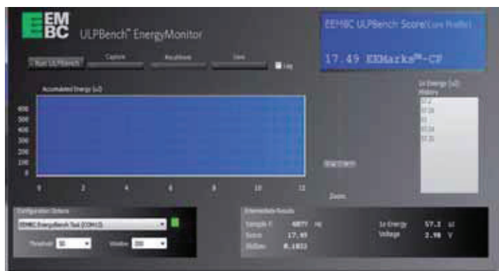
Fig. 1 – La piattaforma ULPBench del consorzio EEMBC consente ai progettisti di valutare le prestazioni dei microcontrollori a consumo ultra-basso con criteri autorevoli e orientati alle applicazioni
