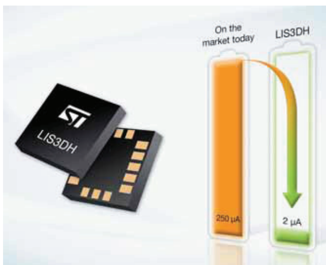
Fig. 1 – Il sensore di accelerazione LIS3DH di ST è caratterizzato da un consumo energetico di appena 2 µA in modalità Ultra Low-Power
