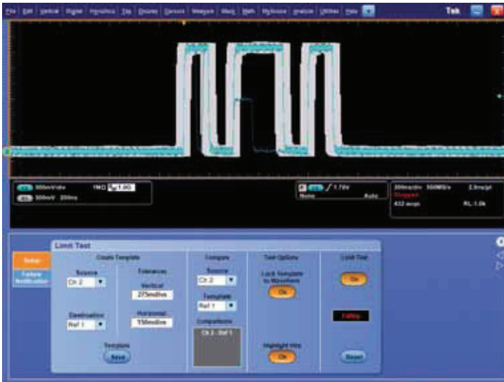
Fig. 2 – Uso di una maschera per rilevare i problemi del segnale
