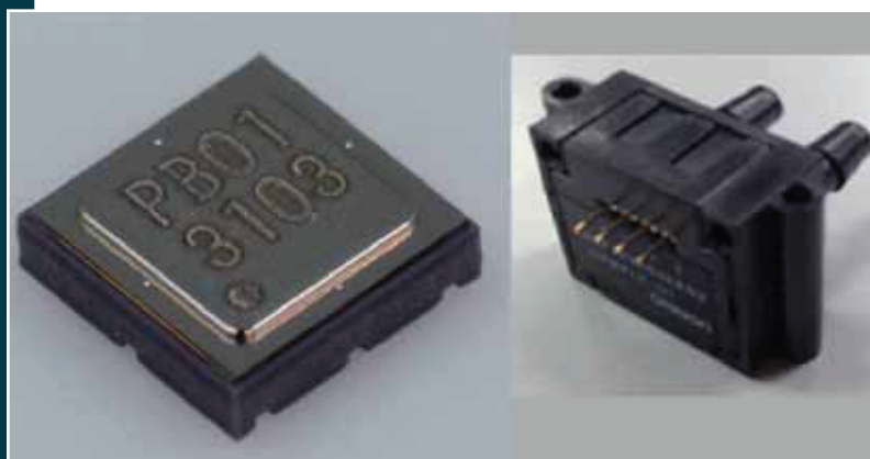
Fig. 3 – Il sensore Mems Omron PB013103 misura le differenze di pressione fino a 6 Pa con risoluzione di 0,06 Pa ed è ideale per le applicazioni biomedicali indossabili
