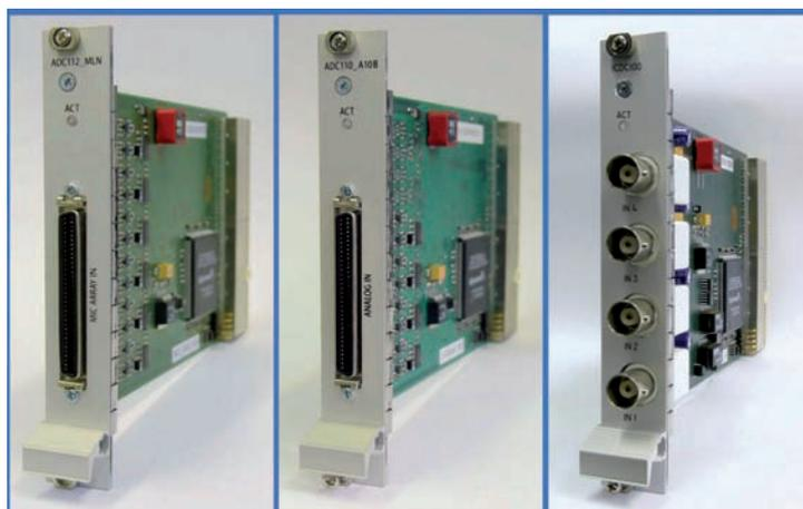
Fig. 1 – L'acquisizione dati per le verifiche di rumore e insonorizzazione con il sistema mcdRec di Acoustic Camera si può fare con array di 144 microfoni e campionamento a 24 bit di 192 KS/s
