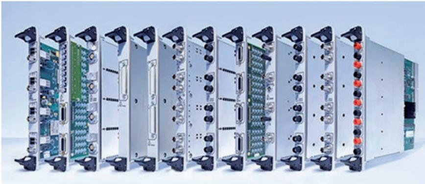
**Fig. 4 – Il sistema modulare HBM Genesis HighSpeed si può comporre fino a ottenere 4576 canali con velocità e precisione da scegliere da 20 KS/s a 100 MS/s e da 14 fino a 24 bit**
