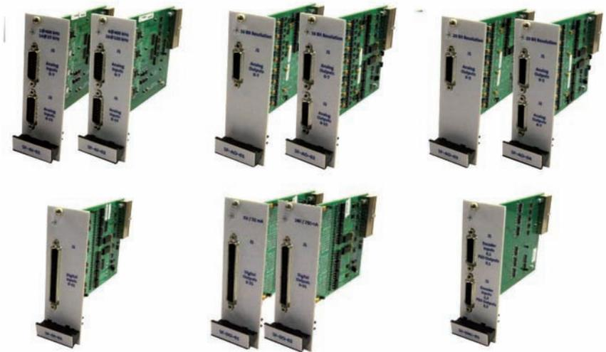
Fig. 2 - Il versatile sistema di acquisizione dati Aerotech Sensor Fusion ha 16 ingressi analogici, 32 ingressi digitali e altrettante uscite particolarmente adatte al controllo in tempo reale delle movimentazioni industriali
