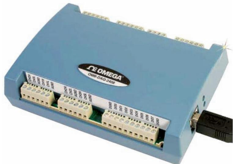
**Fig. 5 – Uno stadio di conversione A/D di tipo Sigma Delta con risoluzione di 24 bit e velocità di 1,1 KS/s caratterizza il modulo di acquisizione per tensioni e temperature Omega OMB-DAQ-2408**
