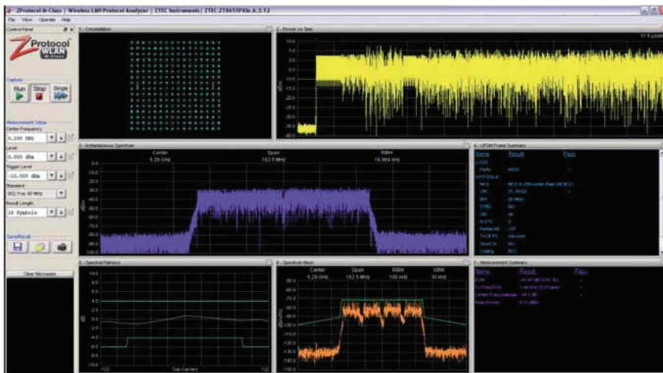
Fig. 4 – L'interfaccia grafica offerta dal software ZProtocol consente di verificare in tempo reale la qualità della connessione a radiofrequenza
