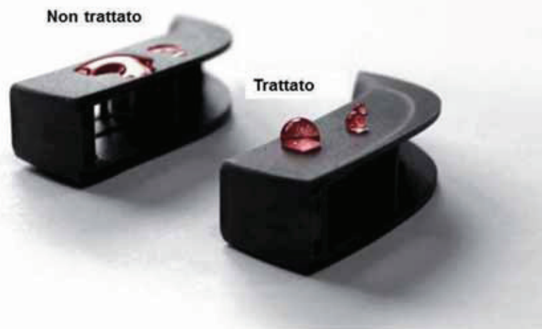
Fig. 2 - Confronto tra componenti non trattati e componenti trattati (Foto: Diener electronic)
