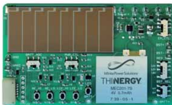
Fig. 11 - Kit di valutazione a MEC/Energy Harvesting di Infinite Power Solutions che utilizza una cella solare amorfa
