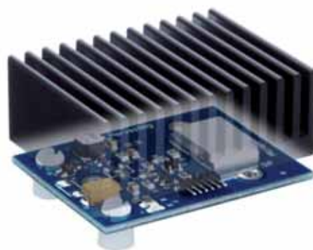
Fig. 2 - Modulo termogeneratore TE-Core della tedesca Micropelt per applicazioni di EH ultra-low power
