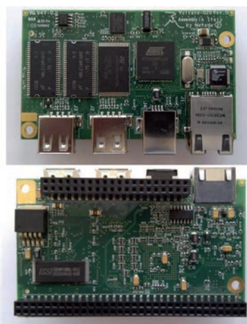
Fig. 2 - Le schede Metodo2 Vulcano basate su micro Atmel a 32 bit offrono una varietà di opzioni che ne permettono la configurazione secondo le esigenze applicative
