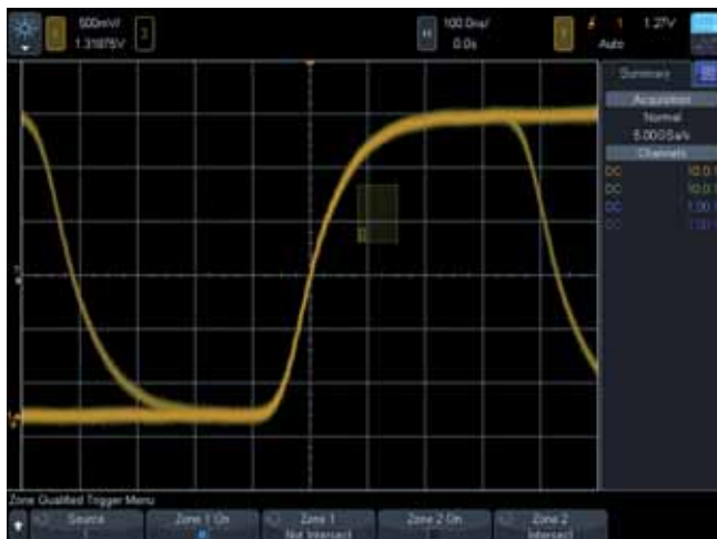
Fig. 3 - Cattura e visualizzazione delle sole forme d'onda "normali" usando il trigger a zona
