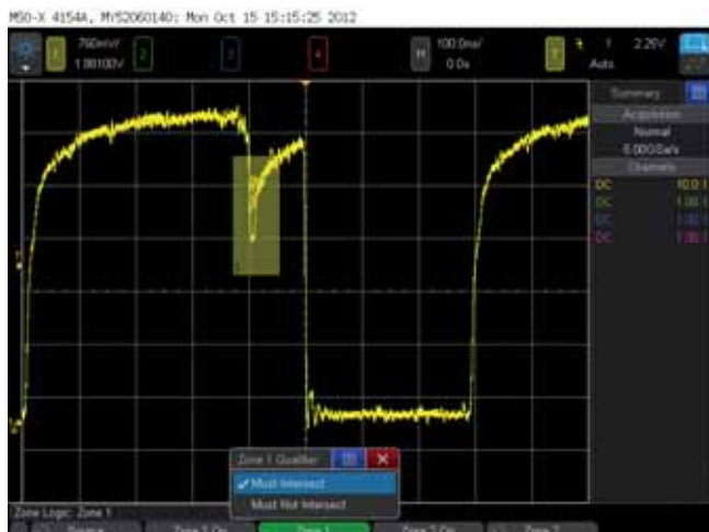
Fig. 5 - Utilizzo del trigger a zona per isolare uno stato metastabile poco frequente
