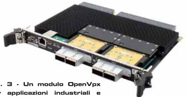
**Fig. 3 - Un modulo OpenVpx per applicazioni industriali e militari di categoria data-intensive (Fonte: Mercury Systems)**
