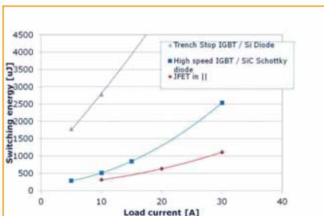
Fig. 6 – Confronto con V_{ds}=800V , T_j=75^\circ C e R_g=3\Omega fra le perdite di commutazione in accensione e in spegnimento di un JFET SiC da 1200V e 50 mOhm in confronto a un IGBT con diodo Schottky SiC integrato e a un IGBT con diodo Si ad alta velocità
