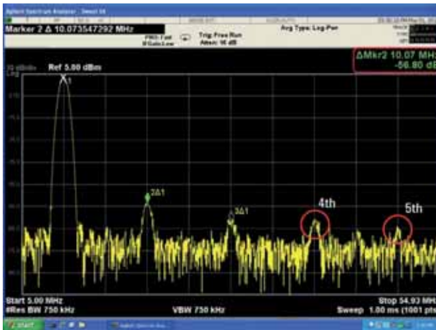
Fig. 2 - Le armoniche del segnale generato con la sintesi digitale diretta (DDS)
