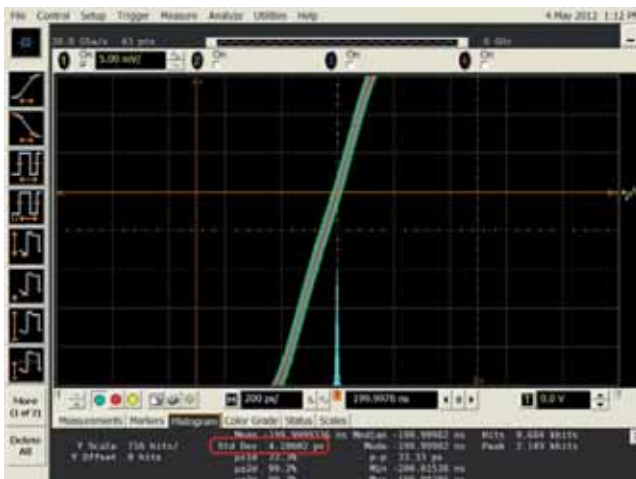
Fig. 3 - Misura di jitter su un segnale generato con Trueform
