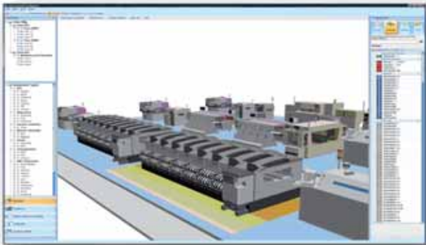
Fig. 2 - Modello delle linee di assemblaggio definito in Valor MSS
