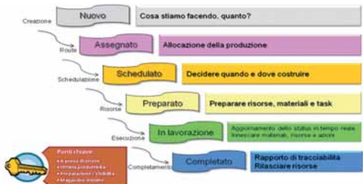
Fig. 3 - Flusso concettuale della produzione di schede elettroniche, con pianificazione e preparazione delle varie fasi
