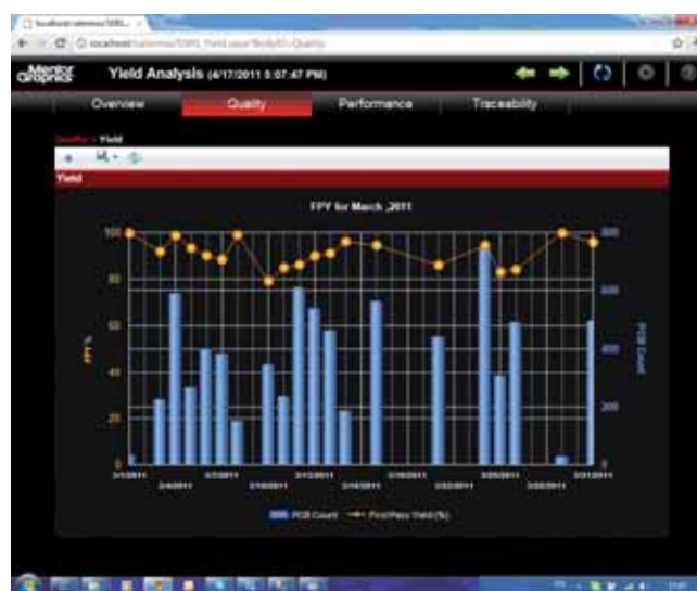
Fig. 5 - Esempio di analisi delle rese di produzione
