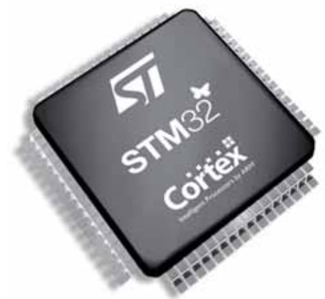
Fig. 3 - STM32 di STMicroelectronics abbinato al diffuso processore ARM Cortex-M3 con periferiche allo stato dell'arte
