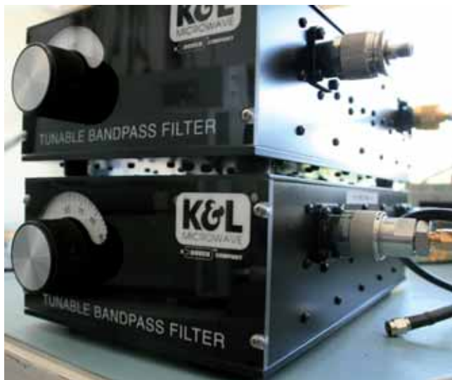
Fig. 2 - Uno dei pezzi più importanti per la caratterizzazione ADC - un filtro passa-banda sintonizzabile
