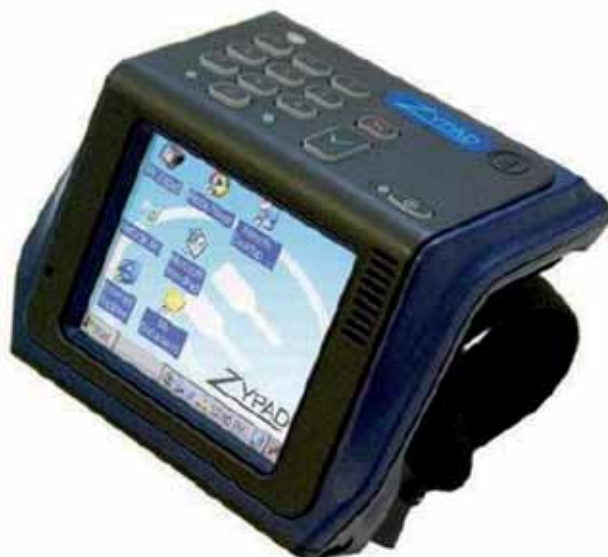
Fig. 1 – Il computer indossabile Zypad di Eurotech
