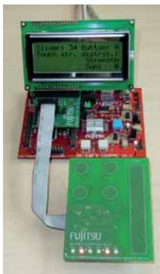
Fig. 5 - Il Touch Sensor Controller (TSC) di Fujitsu offre una soluzione in sostituzione di interruttori di ogni tipo
