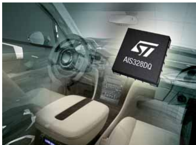
Fig. 1 - L'AIS328DQ è un accelerometro low-g a tre assi di STMicroelectronics destinato ad applicazioni automotive a basso consumo
