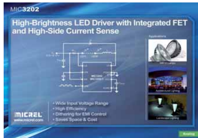
Fig. 4 - Per l'illuminazione a LED, Micrel ha presentato anche le famiglie MIC3201/02/03 che permettono di pilotare i LED con una efficienza anche del 90%
