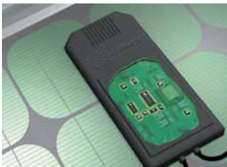
Fig. 2 - Il chipset SolarMagic SM3320 di National Semiconductor consente di ridurre le perdite di energia dei pannelli solari causate da disadattamenti
