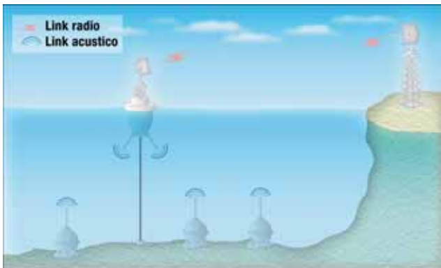
Fig. 4 - Acquisizione dati in ambiente marino
