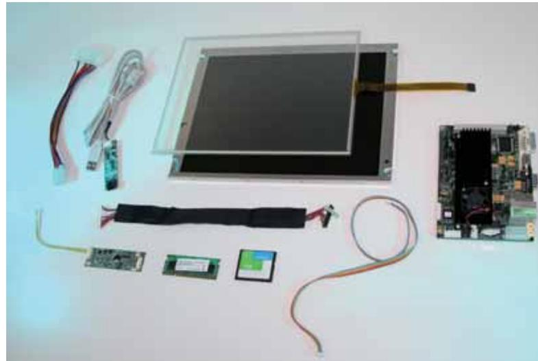
Fig. 1 - Il kit per display di Rutronik risulta composto da un display TFT, un convertitore per retroilluminazione, una soluzione touch che comprende il controller, una scheda embedded, il supporto di memorizzazione e i relativi cavi
