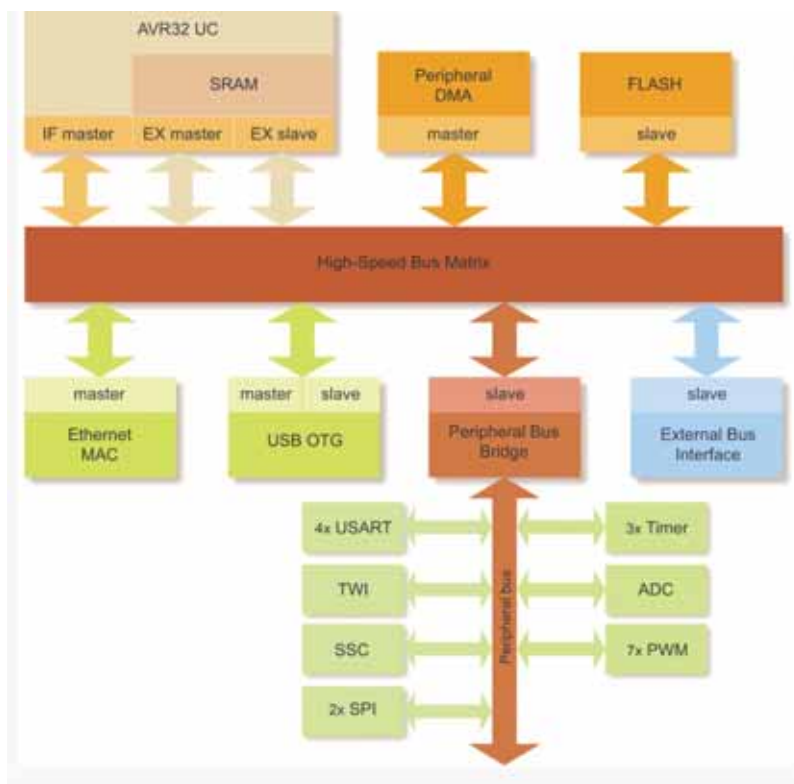
Fig.3 - Schema a blocchi della serie di dispositivi UC3 di Atmel
