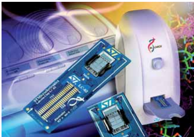
Fig. 3 – Il sistema per biomedico In-Check con la scheda di analisi Lab-on-Chip di produzione ST, basata su chip Mems
