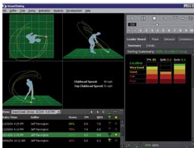
Fig. 6 – Grazie alle tecnologie Mems di Analog Devices, la mazza da golf è in grado di registrare i movimenti del giocatore e trasmetterli a un computer
