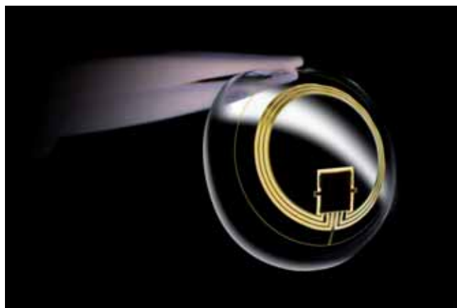
Fig. 2 – Un'innovativa applicazione dei dispositivi Mems per il monitoraggio del glaucoma, scaturito dalla collaborazione fra ST e Sensimed AG
