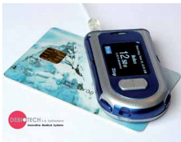
Fig. 5 – Pompa a microinfusione per l'insulina prodotta da Debiotech, che utilizza il chip di ST
