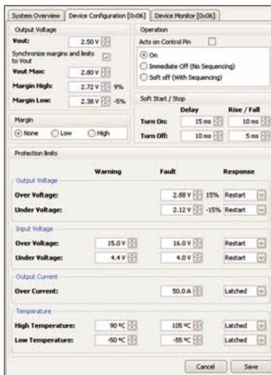
**Fig. 3 – L'interfaccia utente grafica del kit di valutazione dei componenti la famiglia 3E semplifica notevolmente la configurazione del dispositivo**
