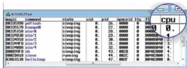
Fig. 7 - L'awareness di Linux permette di esaminare l'utilizzo delle risorse del sistema operativo, come ad esempio i task in esecuzione
