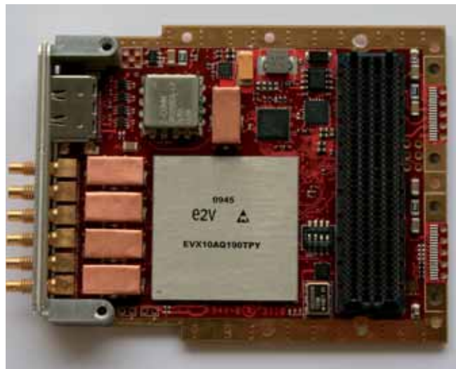
Fig. 4 - La scheda mezzanino FMC126 di 4DSP
