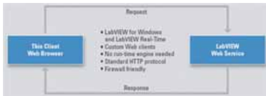
Fig. 2 - Le interfacce thin-client standard possono invocare VI LabVIEW
