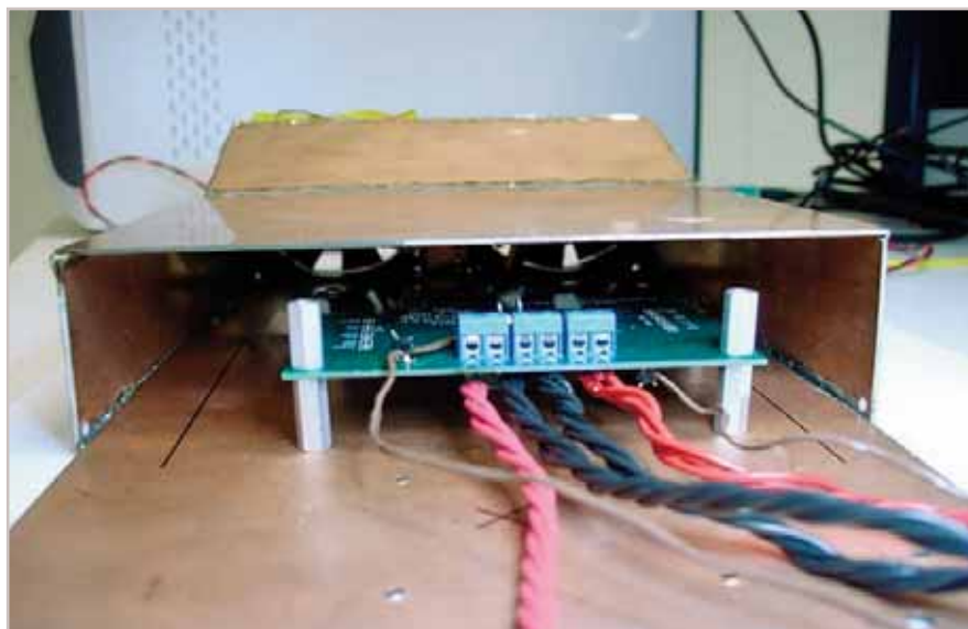
Fig. 1 - La scatola - usata per la misura di deriva termica - circonda la scheda di valutazione EvKit e mantiene un flusso d'aria costante al fine di assicurare la ripetibilità delle misure da eseguire
