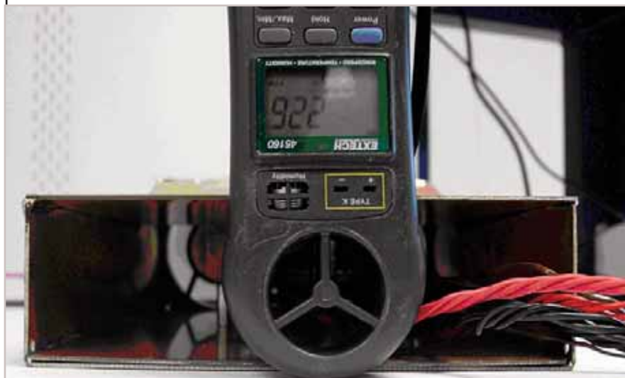
Fig. 2 - Un misuratore di flusso d'aria viene usato - sul lato aperto della scatola - per calibrare il sistema di test, preparandolo per le successive misure termiche
