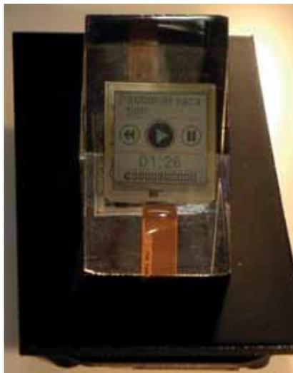
**Fig. 2 – In questo tipo di schermo ogni pixel è dotato di una memoria di 1 bit**
