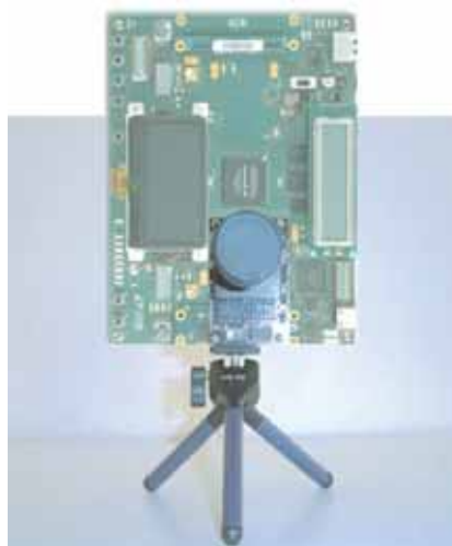
Fig. 5 - Il sistema di sorveglianza completo basato sulla piattaforma di sviluppo Cyclone III di Altera
