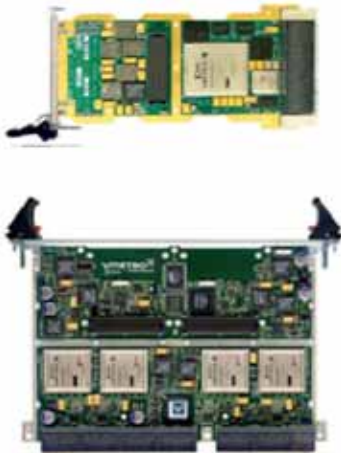
Fig. 2 - Schede in formato 3U e 6U predisposte per alloggiare i mezzanini FMC, semplificando molto l'installazione e la manutenzione degli Fpga nelle applicazioni industriali
