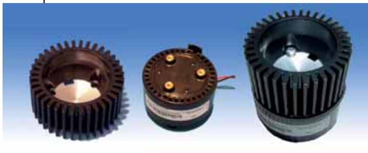
Fig. 6 – Il nuovo progetto di riferimento abbinava un modulo SynJet di Nuventix a un dissipatore, sulla base del quale è stata fissata la scheda che reca i componenti di National Semiconductor
