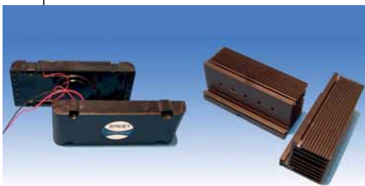
Fig. 7 – Il modulo SynJet a basso profilo viene utilizzato per il raffreddamento fanless del gruppo illuminante Philips Fortimo da 2000 lumen che dissipa 45W
