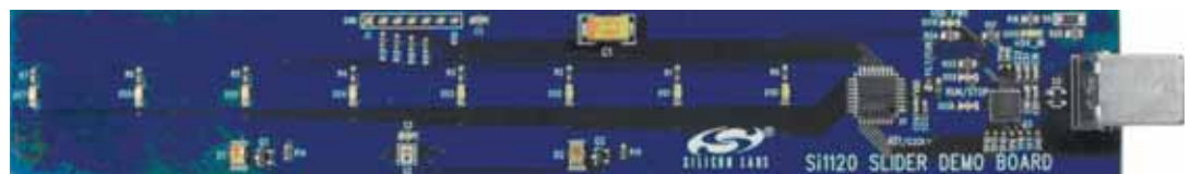
Fig. 5 – Schema dimostrativa IrSliderEK del cursore touchless di Silicon Labs
