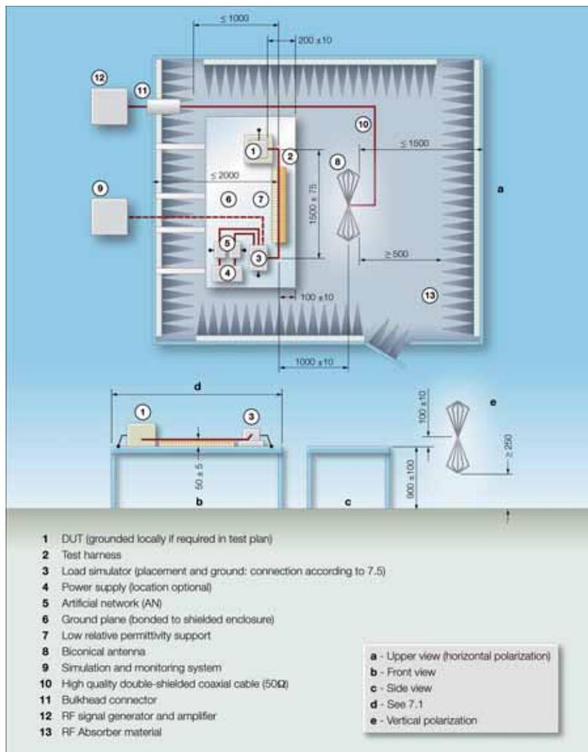
**Fig. 2 - Test immunità radiata su componente**
