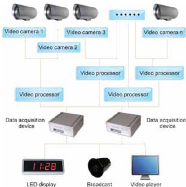
**Fig. 2 - Diagramma a blocchi del sistema EVOC MEC-5003**
