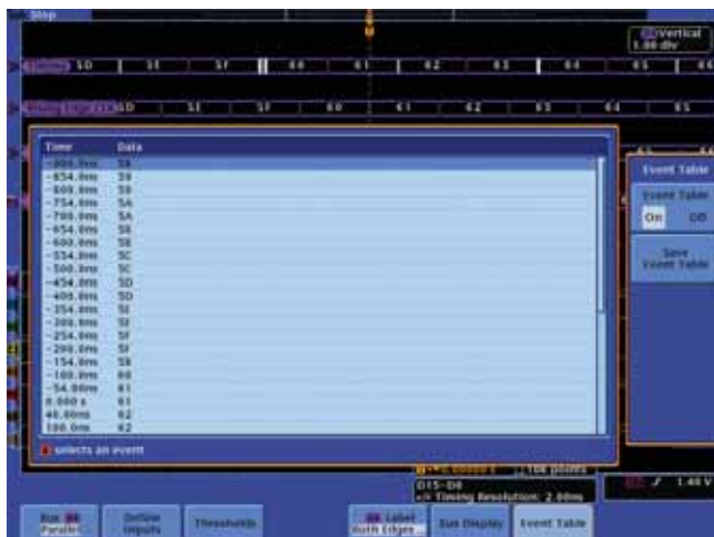
Fig. 1 - I dati decodificati vengono riportati in una tabella degli eventi simile alla visualizzazione di acquisizione dello stato di un analizzatore logico
