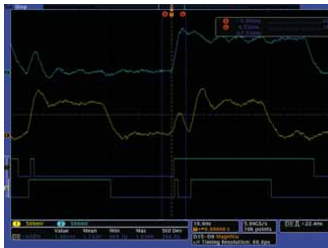
Fig. 9 - Crosstalk del fronte di salita fra due segnali PECL a basso voltaggio che generano anomalie
