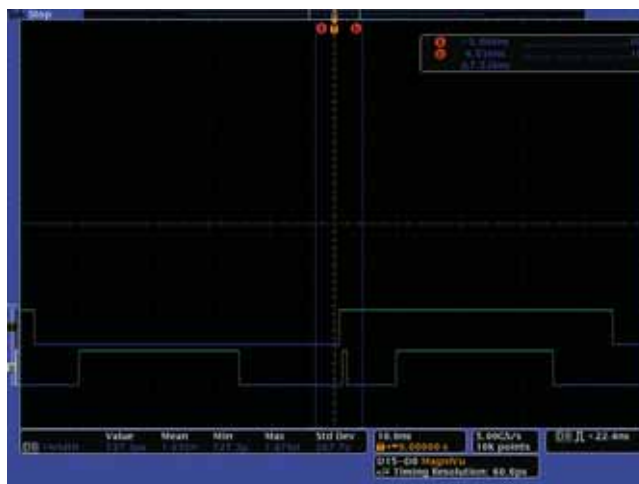
Fig. 8 - L'oscilloscopio MSO ha eseguito il trigger su una acquisizione del segnale PECL finale a basso voltaggio di 727,3 ps
