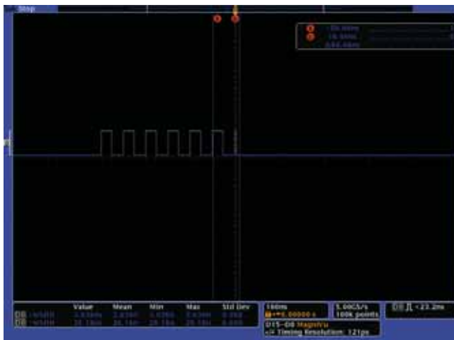
Fig. 6 - L'oscilloscopio MSO ha eseguito il trigger sull'errore di durata dell'impulso positivo, pari a 3,636 ns
