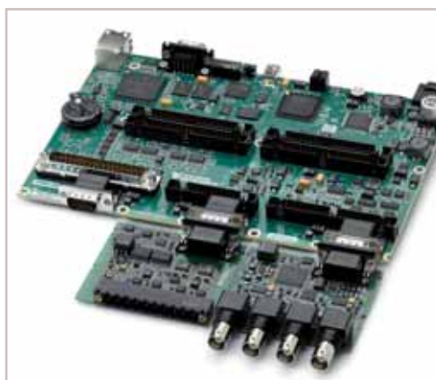
Fig. 2 - È possibile connettere fino a tre degli oltre 60 moduli di I/O e comunicazione della Serie C per fornire ulteriori funzionalità di I/O a qualsiasi dispositivo Single-Board RIO; in alternativa è possibile realizzare i propri moduli di I/O customizzati
