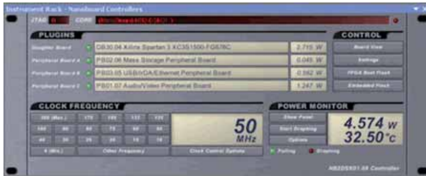
Fig. 2 – Il monitoraggio della potenza può essere una parte integrante del pannello di interfaccia della scheda di sviluppo. Le letture relative all’FPGA e alle schede plug-in periferiche vengono visualizzate e registrate
