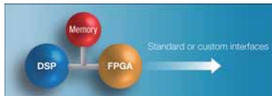
Fig. 1 – L'approccio che prevede l'abbinamento tra un DSP e un FPGA garantisce maggiori doti di flessibilità
