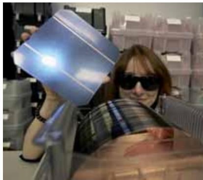
Fig. 2 - Wafer di silicio in Ibm, riciclati per la realizzazione di pannelli solari
