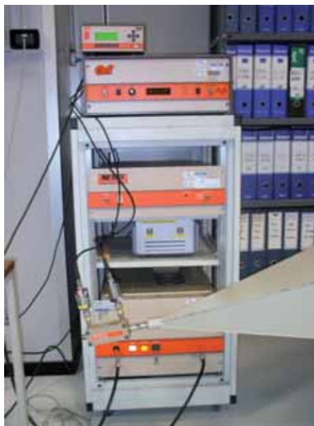
Fig. 4 – Strumentazione da laboratorio per cella GTEM
