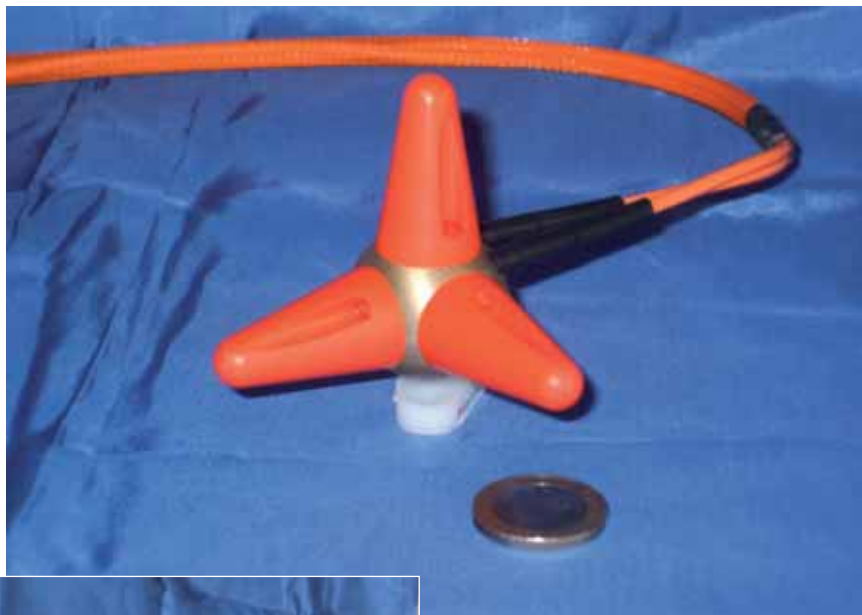
Fig. 6 – Sensore isotropico di campo elettrico e sua unità di interfaccia
