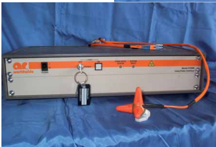
Fig. 6 – Sensore isotropico di campo elettrico e sua unità di interfaccia
