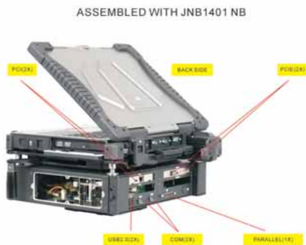
Fig. 2 - Evoc JNB-1401 ospita nella scheda madre l'innovativa Docking Port con ampie possibilità di espansione
