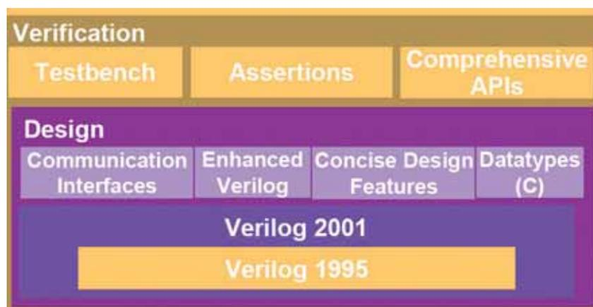
**Fig. 2 - Parti della struttura di System Verilog**
