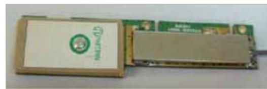
l'antenna patch. Il consumo particolarmente ridotto ne consente l'impiego in applicazioni portatili. Partron inoltre realizza ricevitori Gps completi dotati della parte RF, chipset e antenna attiva.
