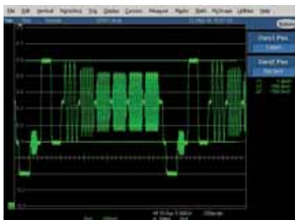
Fig. 7d - Segnale "NTSC Multiburst" trasmesso su cavo CAT5 lungo 450 metri con equalizzazione
