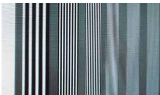
Fig. 1 - Immagine TV di un segnale video "NTSC Multi-burst" non distorto
