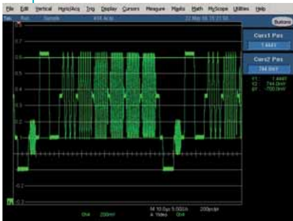
Fig. 2 - Immagine di un segnale "NTSC Multiburst" non distorto trasmesso su un metro di cavo CAT5
