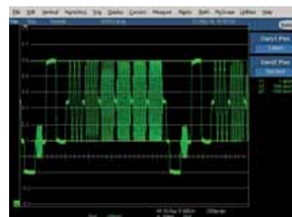
Fig. 7c - Segnale "NTSC Multiburst" trasmesso su cavo CAT5 lungo 300 metri con equalizzazione
