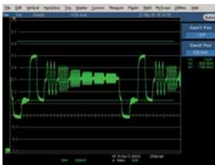
Fig. 5c - Segnale "NTSC Multiburst" trasmesso su cavo CAT5 lungo 450 metri
