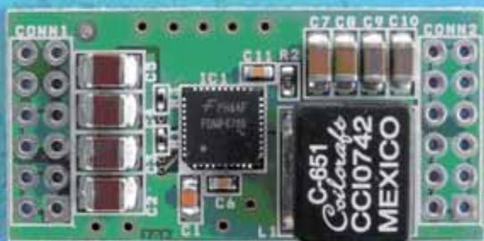
**Fig. 5 - Stadio di potenza progettato con un DrMOS FAN6700 per design compatti**
