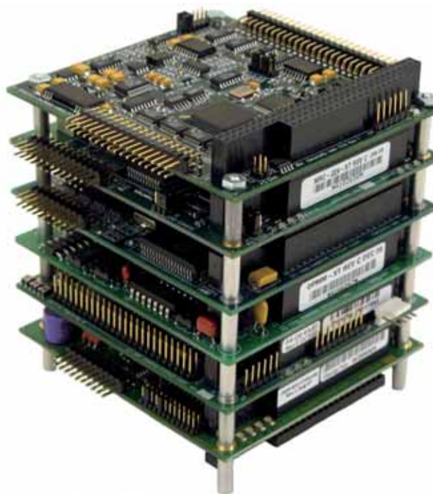
Fig. 1 - I progetti più datati prevedono "pile" di CPU e schede di I/O
