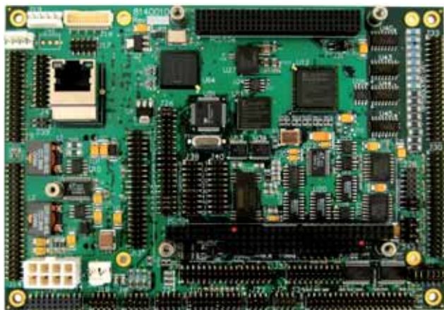
Fig. 2 - La baseboard Neptune dotata di un gran numero di I/O sostituisce la "pila" di schede di figura 1
