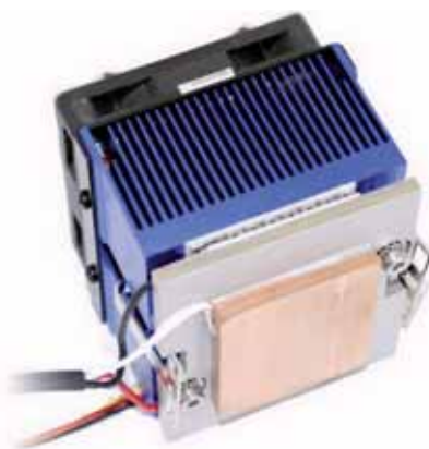
Fig. 8 - Un esempio d'impiego di una cella di Peltier interposta fra package e dissipatore con ventola
