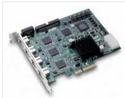
Windows XP o Windows Vista, supporta inoltre la funzione 'power over cable', la quale consente alle videocamere dotate di interfaccia leee 1394.b di essere alimentate direttamente dalla scheda, riducendo così l'ingombro del sistema.
